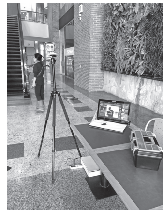
別のショッピングセンターでもカメラ一体型検温センサーで検温、パソコンで記録
