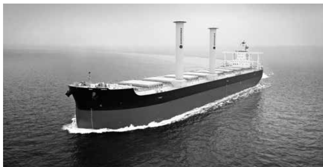
VALE社と合意した風力推進補助装置ローターセイルを設置した本船イメージ
