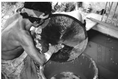
図2 エルカジャオの金採掘人が行うアマルガム法。写真：山田篤美
