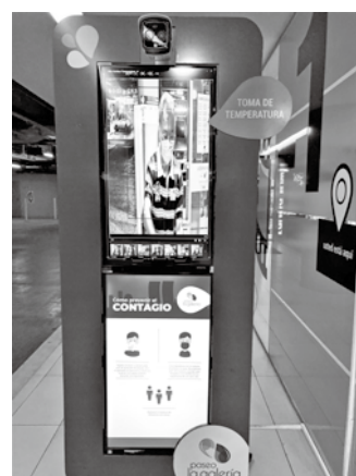
ショッピングセンターの入り口には、ビデオカメラと温度センサーが一体化したモニターが設置されている
